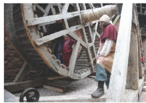
De droles de hamsters pour faire fonctionner cette roue, qui est en réalité un engin de levage.
