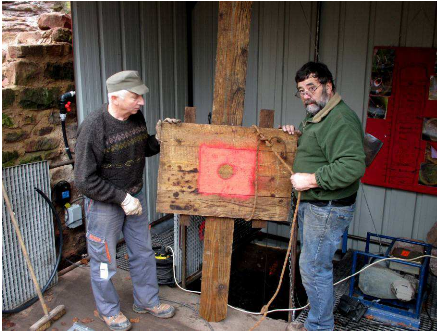
Cible qui sera au fond du puits pour mesurer la hauteur du niveau d'eau.
