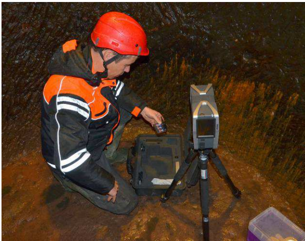
Préparation du scannage du fond du puits
